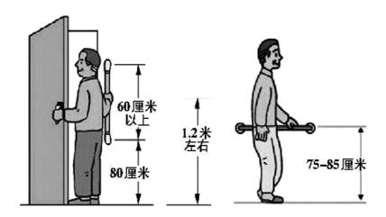
江苏南京的适老化改造员曾志峰给出解答:部分老年人在自行安装扶手时,对于安装位置的选择不是很恰当,从而导致扶手没能发挥应有作用。一般来说,老人抬手的范围,会影响扶手的安装高度。最简单的方法就是,先尝试做出相应的抓握动作,去找到最合适的使用位置,然后在对应的行动位置上安装扶手。
